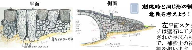
左平面スケッチは壁石に工夫された長尺石材で、補強土の役割を担います。
